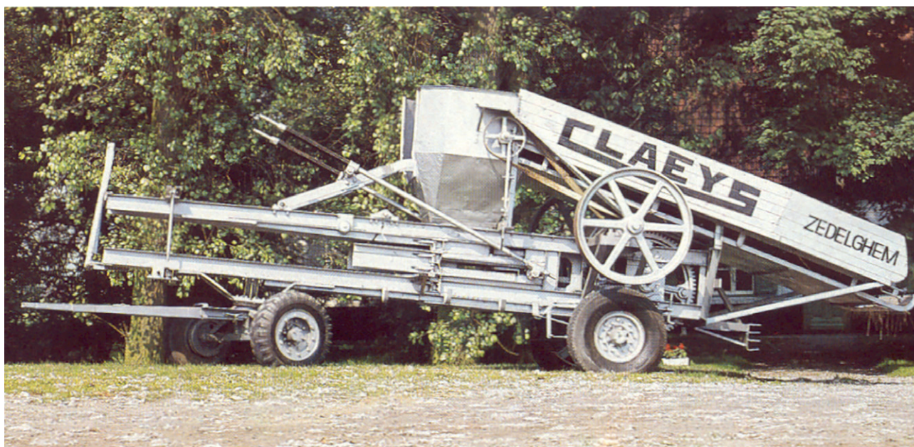
Machine waarmee stro onder hoge druk wordt geperst en met ijzerdraad wordt gebonden tot balen, 1940-1960. Collectie CAG ( https://cagnet.be/item/B00002700 )
